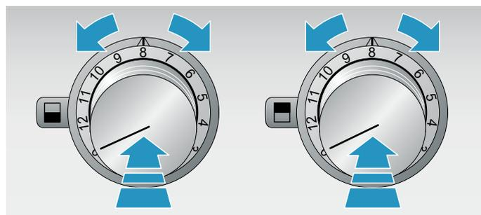
Podświetlane pierścienie za pokrętkami obsługi migają, dopóki trwa nagrzewanie urządzenia. Po osiągnięciu ustawionego stopnia mocy grilla pierścienie świecą w sposób ciągły. W przypadku stopnia mocy grilla 12 faza nagrzewania trwa ok. 15 minut.
