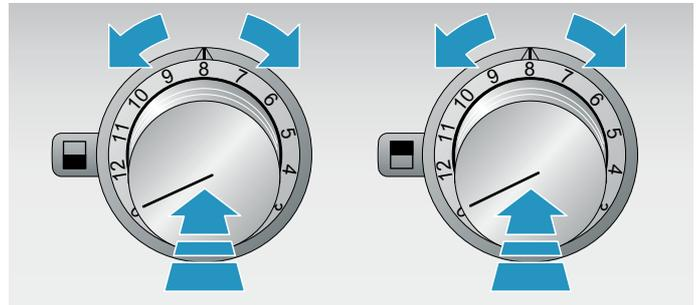
Kumanda düğmelerinin arkasındaki halka lambalar, cihaz ısındığı sürece yanıp sönür. Ayarlanan sıcaklığa erişildiğinde yanar halka sürekli olarak yanar. Izgara kademesi 12'de ön ısıtma süresi yakl. 15 dakika sürer.
