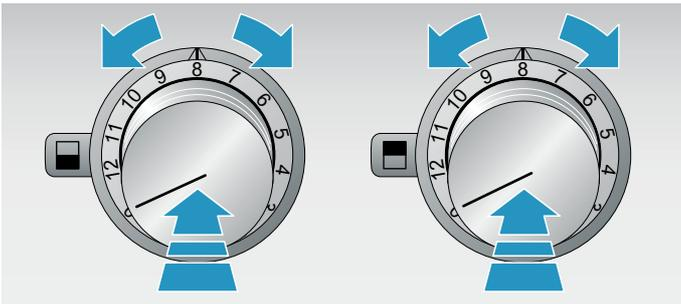
Světelné kroužky za ovládacími knoflíky blikají, dokud se spotřebič rozehřívá. Po dosažení nastaveného stupně grilování světelné kroužky svítí. U stupně grilování 12 trvá fáze předehřívání cca 15 minut.
