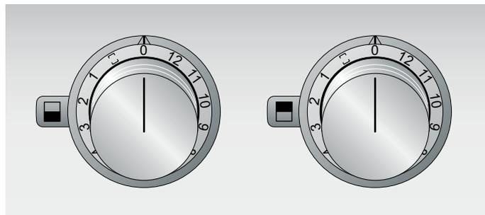
С помощью регуляторов выберите передний или задний нагревательный элемент и режим гриля в диапазоне от 1 до 12.
